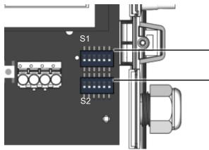
S1 - Dip-Schalter Block 1, Drucksensor 1
